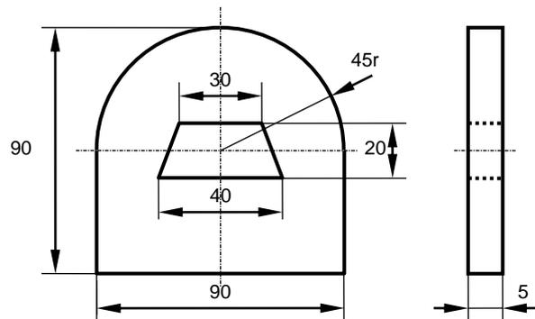
15. Wie gross ist die Masse des gezeichneten Stahlbleches in kg?
